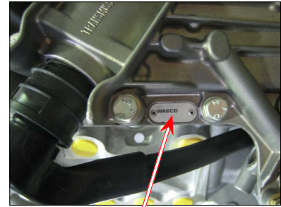
Plaque d'identification des WABCO GS3.3 WABCO GS3.3 l'actionneur de la boîte de vitesses
